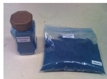
ภาพที่ 2 ลักษณะของผงซี-ไฟโคไซยานินที่ผ่านการทำบริสุทธิ์โดยเทคโนโลยีเมมเบรนและทำแห้งแบบระเหิด (freeze drying) ของห้องปฏิบัติการวิจัยเทคโนโลยีด้านสาหร่าย สถาบันพัฒนาและฝึกอบรมโรงงานต้นแบบ มหาวิทยาลัยเทคโนโลยีพระจอมเกล้าธนบุรี บางขุนเทียน
